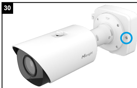
30 Verschließen Sie die Anschlussbox mit einem passenden Schraubendreher.
